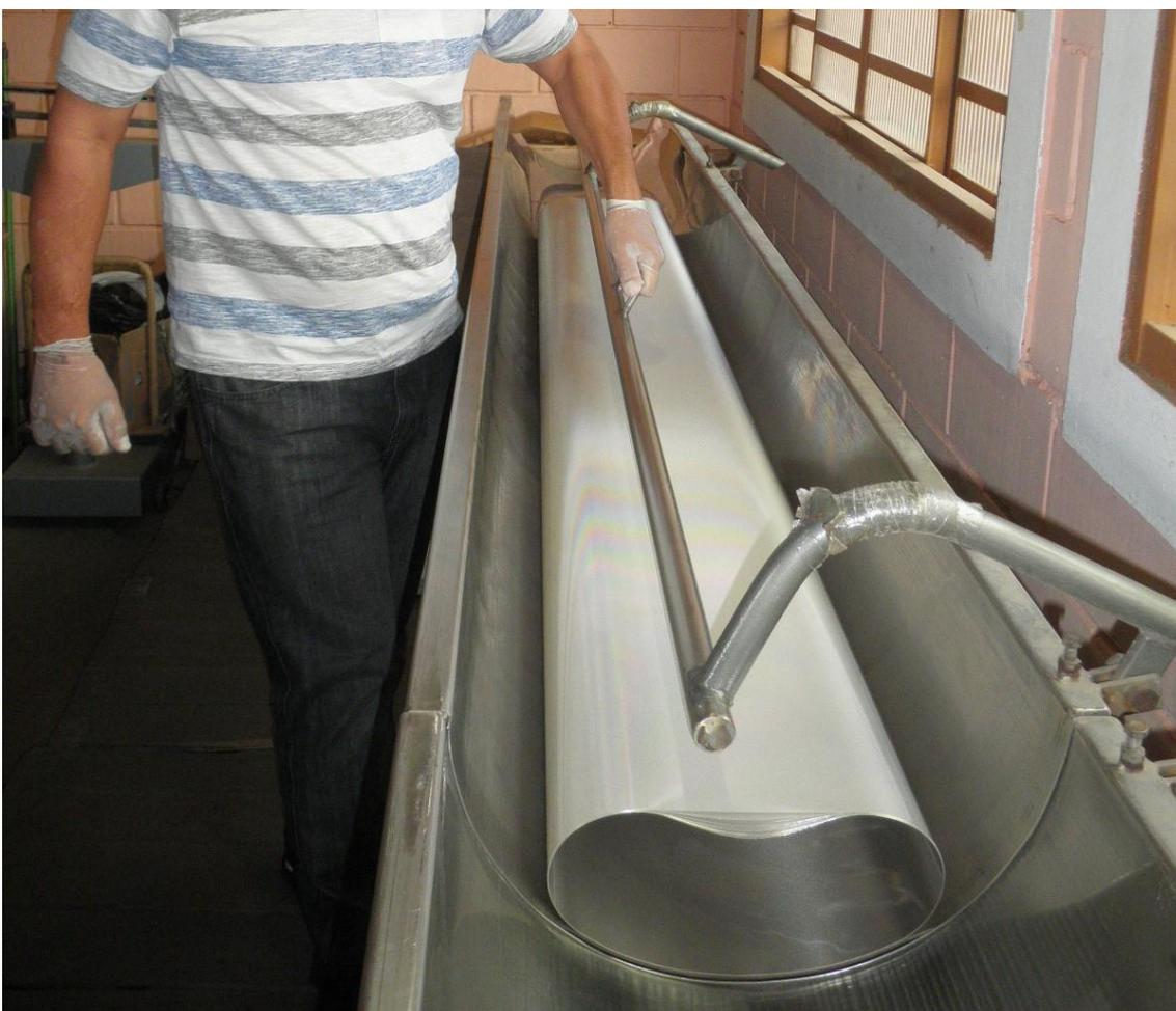
F- Pressionando o braço sobre os cilindros, puxe levemente para fora o primeiro cilindro de dentro do pacote .
