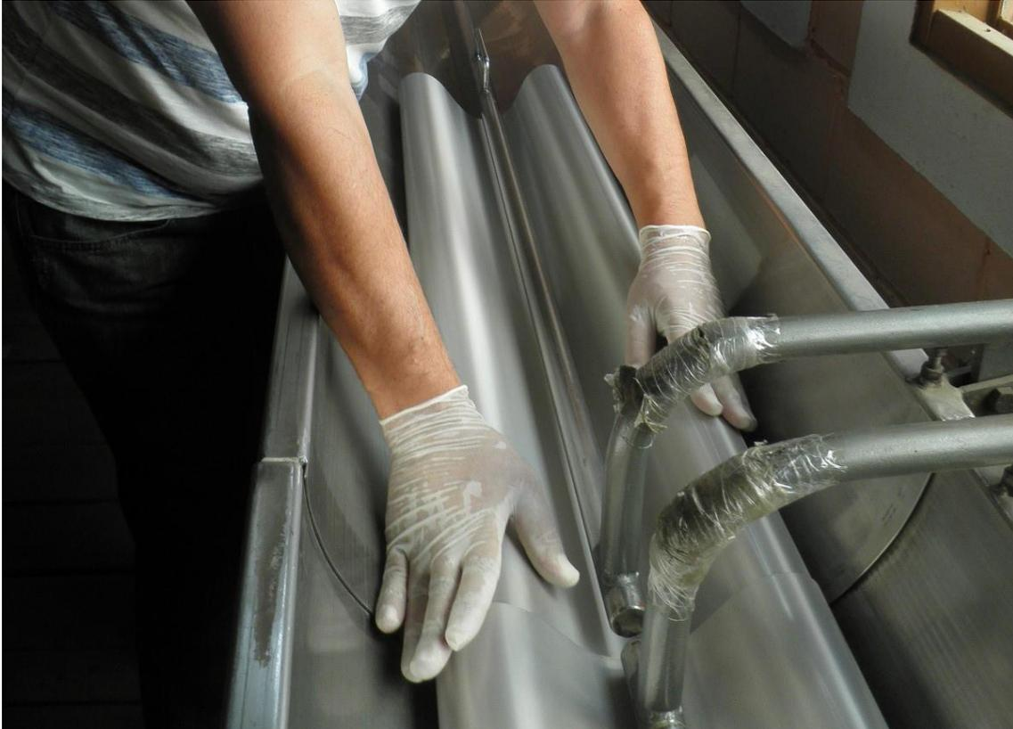
H – Após o cilindro sair totalmente do pacote , levante o segundo braço e retire o cilindro com cuidado , colocando-o de pé para que ele retome a forma original.
